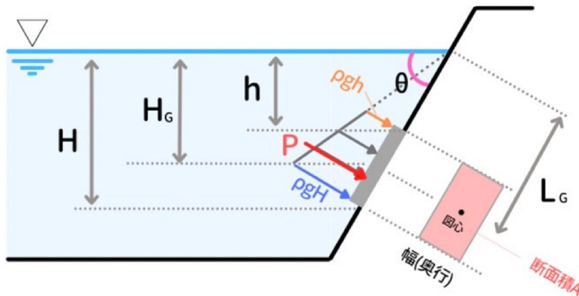
では次は、『傾斜した平面に加わる水圧』の考え方について紹介していきます。
