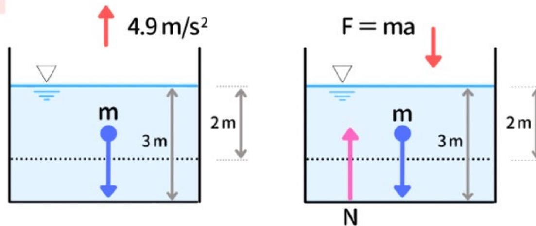
水の重さを $m$ 、重力加速度を $g$ 、加速度を $a$ 、垂直抗力を $N$ として式を立てると
