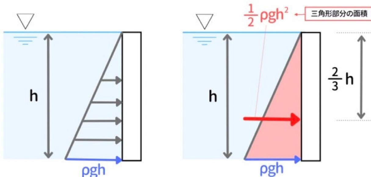
『水圧(静水圧)』というのは、水の重さによる圧力のことです。水の重さですから、深ければ深いほど水圧は大きくなります。
